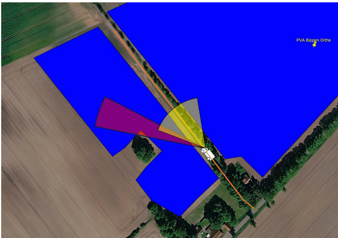
Abbildung 28: Sichtfeld der Verkehrsbeteiligten in Gelb, potenzielle Immissionswinkel in Rot, betroffener Streckenabschnitt in Orange
