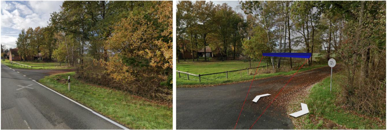
Abbildung 30: Linkes Bild: Keine Sichtverbindung mit dem Solarpark vor dem Abbiegen. Rechtes Bild: Winkel der potenziellen Reflexionen (rote Linien) aus dem Solarpark (blaues Volumen) beim Abbiegen (Quelle: Google Street View und Google Earth)
