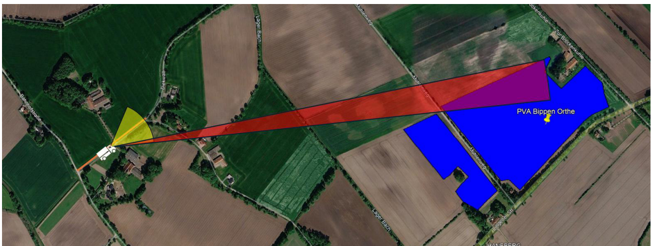
Abbildung 18: Sichtfeld der Verkehrsbeteiligten in Gelb, potenzielle Immissionswinkel in Rot, betroffener Streckenabschnitt in Orange
